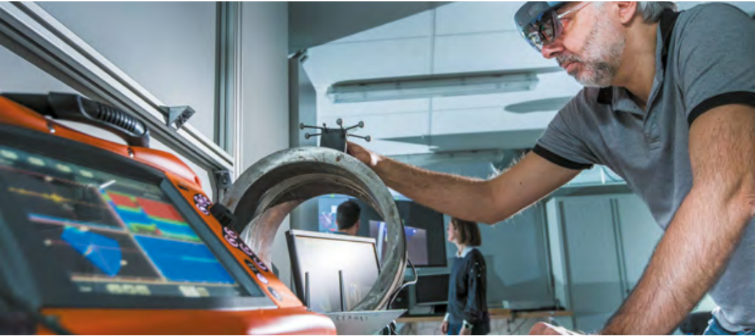
• fig.14 CyberNDT, une solution développée par le CEA-List pour assurer la fiabilité, la traçabilité et la conformité des contrôles non destructifs (CND) manuels.
